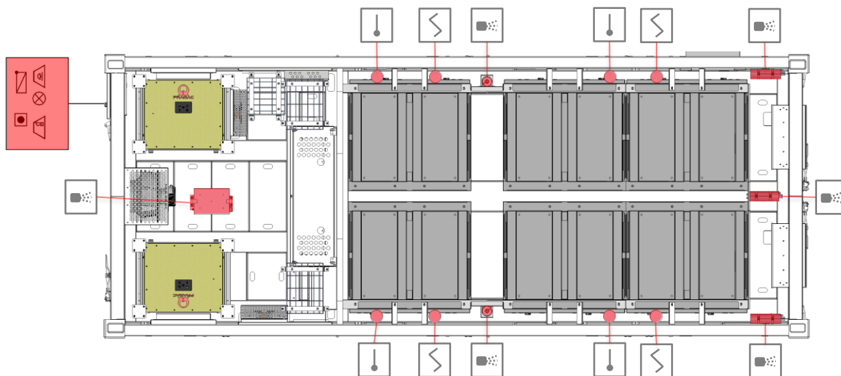
Figura 4-10: Struttura del sistema antincendio di BSC MAX/PWR
