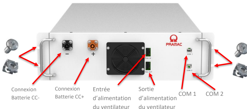
Figure 3-10 : Module de batterie ZYC SIMPO HV Pro
