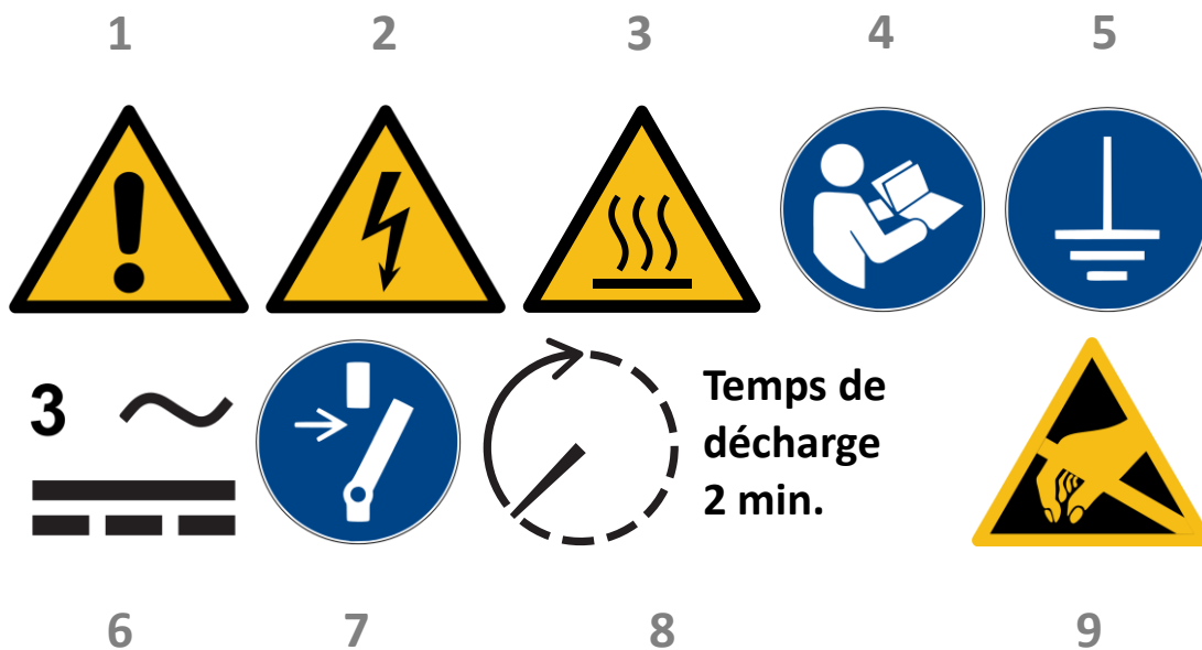
Figure 1-1 : Symboles de l'onduleur de la batterie
