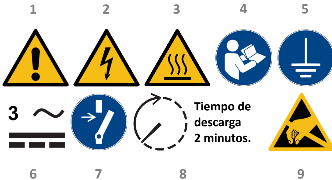
Figura 1-1: Símbolos del inversor de batería
